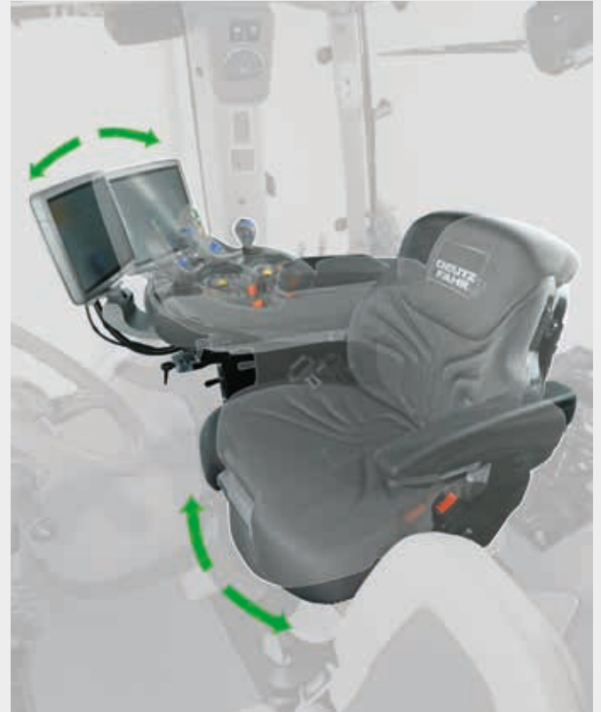
↑ Şimdi tüm TTV modelleri için mevcut: İlave konfor ve işletim kolaylığı için 20°'ye kadar dönebilen koltuk.
