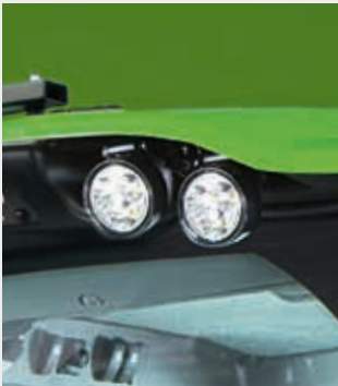
↑ Sayısı 16'yı bulan LED çalışma lambası (IV. nesil, lamba başına 2.500 lm).
