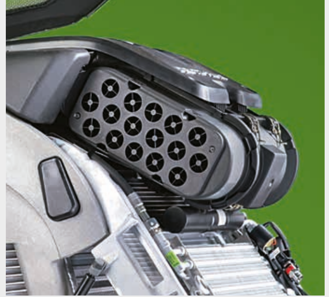
↑ Motor hava filtresinde ön temizleme sistemi: Spiral siklon boruları ve aspiratör hortumları, tozları birincil filtreye girmeden önce %95 oranında uzaklaştırır.
