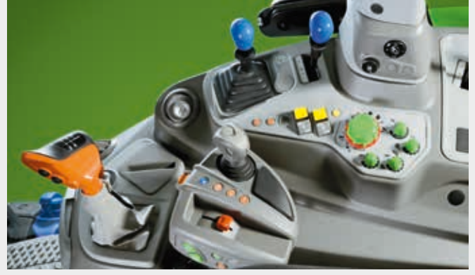
↑ Powershift şanzıman: manüel vites geçişleri ile verimli, çok yönlü şanzıman.
