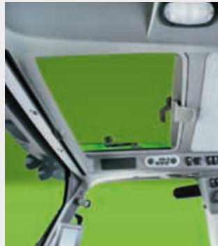
↑ Üç farklı tavan konfigürasyonu. Ön yükleyici çalışması için mümkün olan en iyi görüş.
