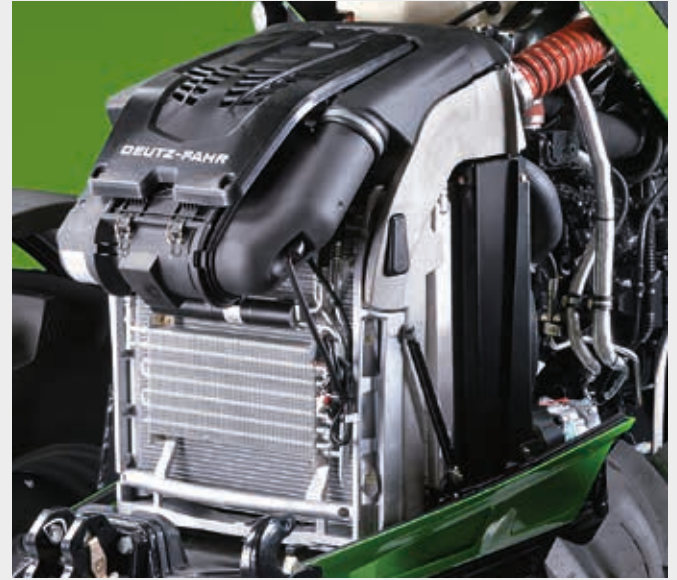
↑ Hava filtresi için PowerCore teknolojisi: Standart filtrelerle kıyasla %20 daha yüksek hava akışı kapasitesi.
