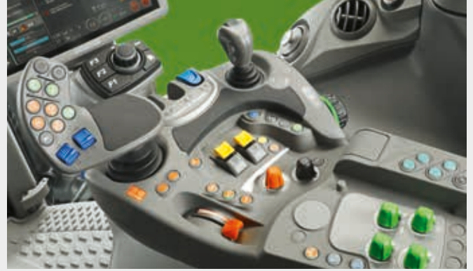
↑ RCshift: Çok işlevli kolçak, elektrohidrolik kontrol valfleri ve iMonitor'a sahip bir varyant olarak; mekanik kontrol cihazları ile donatılmış bir varyant şeklinde sunulur.
