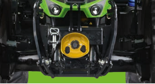
↑ 5.480 kg'ye kadar kaldırma gücüne sahip, konum kontrollü ön bağlantı (TTV modelleri).
