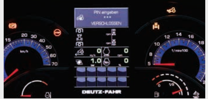
↑ Yeni InfoCenter, sürücüyü güncel tutar: işletim durumu hakkında analog ve dijital bilgiler. Traktör için kod kilidiyle emniyet. PIN ile kilitleyin ve kilidi çözün.
