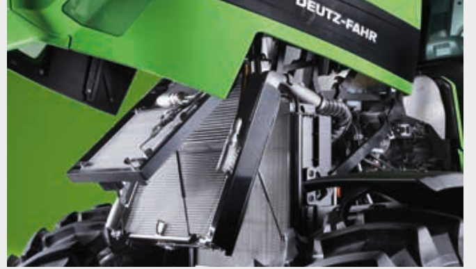
Motor radyatörü kolayca açılıp temizlenebilir.
