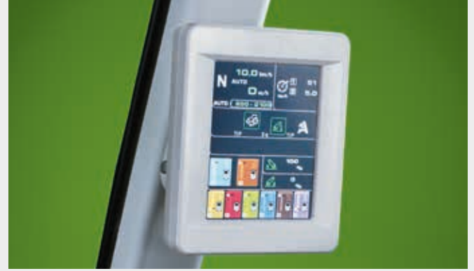
↑ Üç sürüş/çalışma stratejisi seçilebilir: manüel, otomatik ve PTO. Bunlar WorkMonitor'da (Çalışma Ekranı) görüntülenir.
