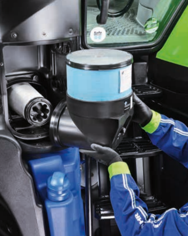
Motor hava filtresinin takılması ve sökülmesi kolaydır.
