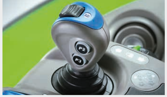
↑ Kalıcı konumlu anahtara sahip çapraz kontrol kolu, üç hidrolik kontrol valfini kontrol eder.
