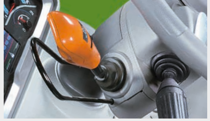
↑ Standart: Powershuttle sistemi. Hassasiyet (sert – orta – yumuşak), başparmakla kullanılan bir kontrol yardımıyla kolaylıkla ayarlanabilir.
