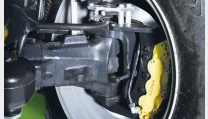
↑ Ekstra emniyetli fren eylemi için, ön akslarda kuru diskli frenler (isteğe bağlı).
