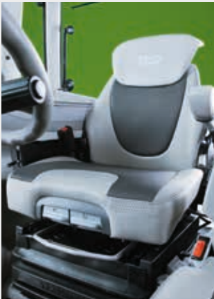
↑ Bireysel süspansiyon seçeneklerine sahip, ayarlanabilir, kısmen deri sürücü koltuğu. Minderli yolcu koltuğu. Yolcular da konforlu bir yolculuk geçirirler.
