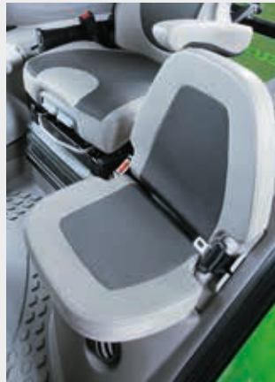
↑ Bireysel süspansiyon seçeneklerine sahip, ayarlanabilir, kısmen deri sürücü koltuğu. Minderli yolcu koltuğu. Yolcular da konforlu bir yolculuk geçirirler.
