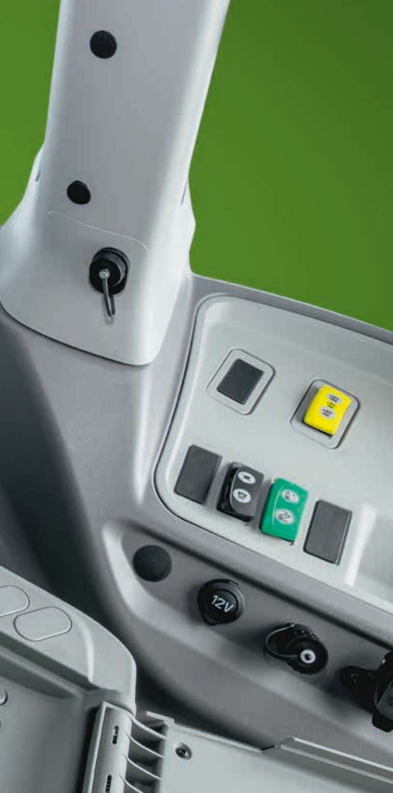
↑ Kalıcı konumlu anahtara sahip çapraz kontrol kolu, üç hidrolik kontrol valfini kontrol eder.
