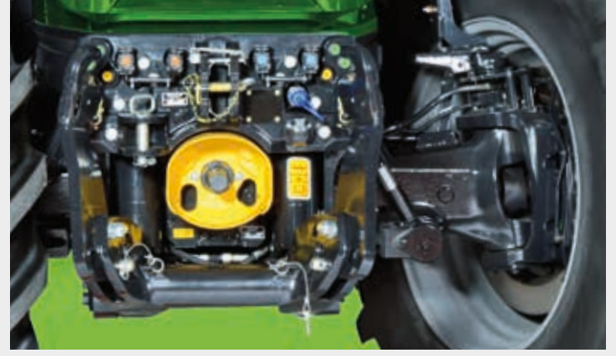
↑ Ön aks: Maksimum süspansiyon etkisi ve 50°'yi bulan dümenleme açısı maksimum çeviklik sağlar.
