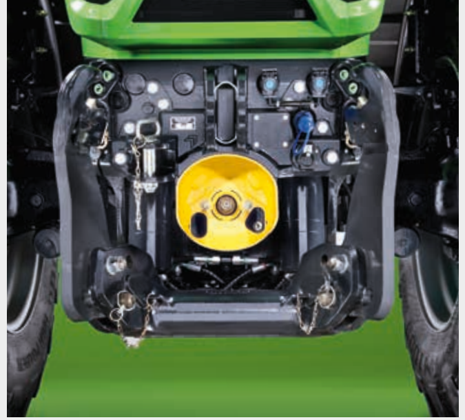
Ön aksa benzersiz düzeyde kısa bir mesafesi olan entegre ön bağlantı. Düşük sarkma. En iyi traktör dengesi.
