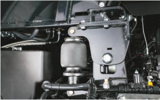
↑ Kabinin konfortu havali süspansiyonunun havali yay elemanları.
