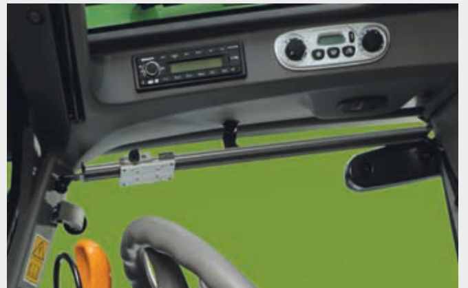
Radio, AC ve ışık kontrol arayüzlerinin yanı sıra kayar monitör montajı.
