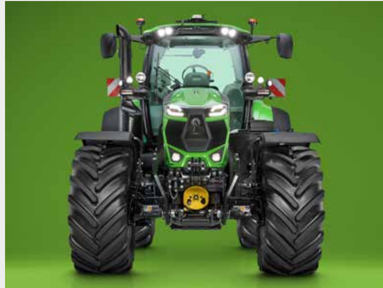
↑ DualSpeed ön PTO, çıkarılabilir bir yivli saplama şaftı sunar ve traktörün her tür tahrik şaftı ile tarımsal ekipmanlara bağlanmasına imkan verir.
