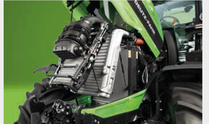
6210 TTV, 6230 TTV ve 6230 TTV HD'nin tek elle erişim koluna ve Powercore hava filtresine sahip alüminyum soğutma sistemi.
