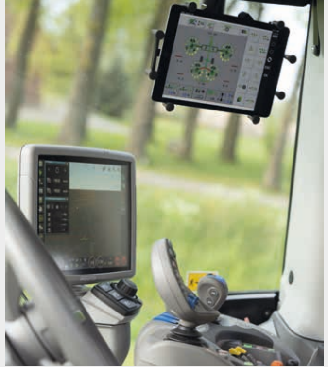
↑ XTEND işlevi SDF Kılavuzun görüntülenmesini sağlar ya da bir ISOBUS tarımsal ekipmanını bir tablet gibi harici bir cihazdan kontrol etmenize izin verir.
