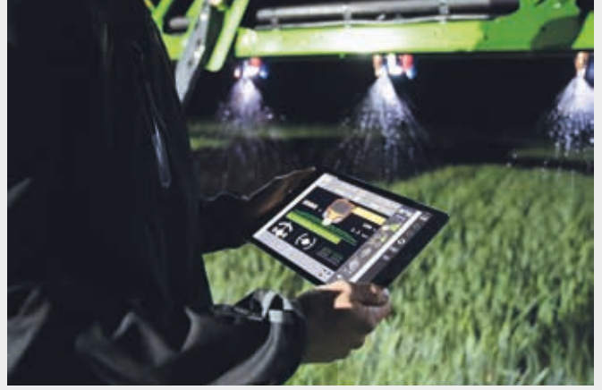
↑ XTEND işlevi, kabin dışındayken tablet üzerinden ISOBUS UT aracılığıyla tarımsal ekipmanların kontrolü.
