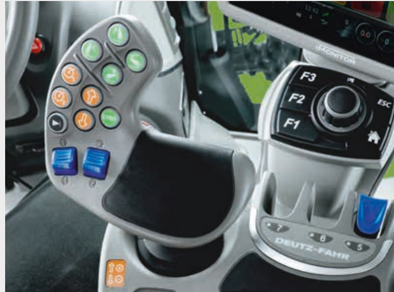
↑ Kaldırıcı düğmeleri, motor ve şanzıman kontrolü, sürülmemiş arazi yönetimi düğmesi ve iki oransal hidrolik valf kontrol birimi ile ergonomik MaxCom kumanda kolu.
