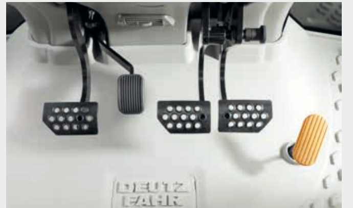
Motor brake PLUS ile pedal düzeni (Pedal debriyaj ile fren pedalları arasında).
