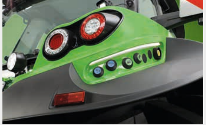
↑ Bir makara valfi, PTO ve arka kaldırcı harici kontrolü için aydınlatmalı basma düğmeleri.
