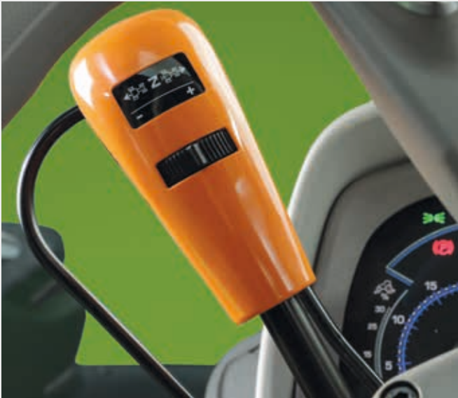
↑ Sense Clutch ve beş ayar seviyesi ile PowerShuttle.
