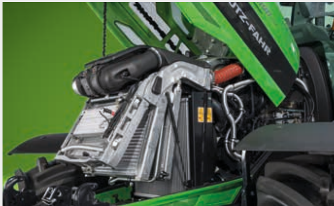
6190 TTV'nin tek elle erişim koluna ve Powercore hava filtresine sahip alüminyum soğutma sistemi.
