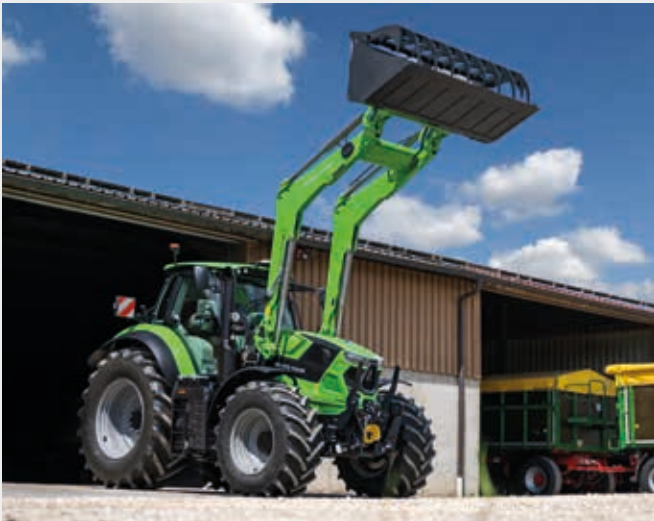
↑ 4,5 m maksimum kaldırma yüksekliği ve 3770 daN koparma kuvveti.
