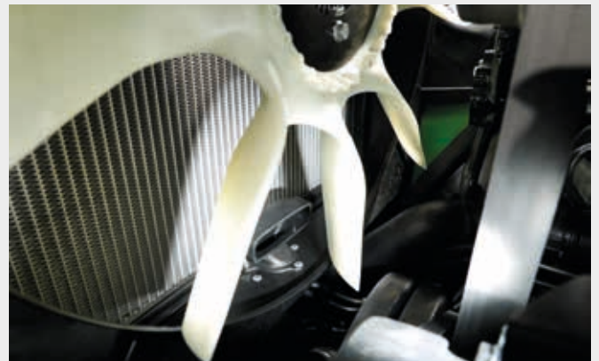
↑ Hava filtresi ön temizleme sistemi için emme hortumuna sahip elektronik viskostatik fan (eVisco) (iri parçacıkların %95'ini filtrelerle ulaşmadan temizler).
