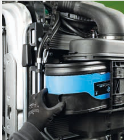
↑ Ön temizleme birimi ile hava filtresi.
