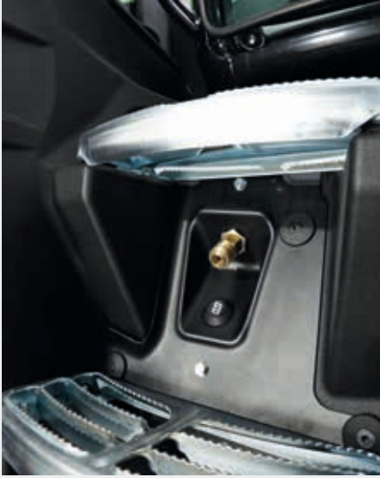
↑ Merdivenlerin altındaki korumalı hava besleme portu ve giriş lambası anahtarı.
