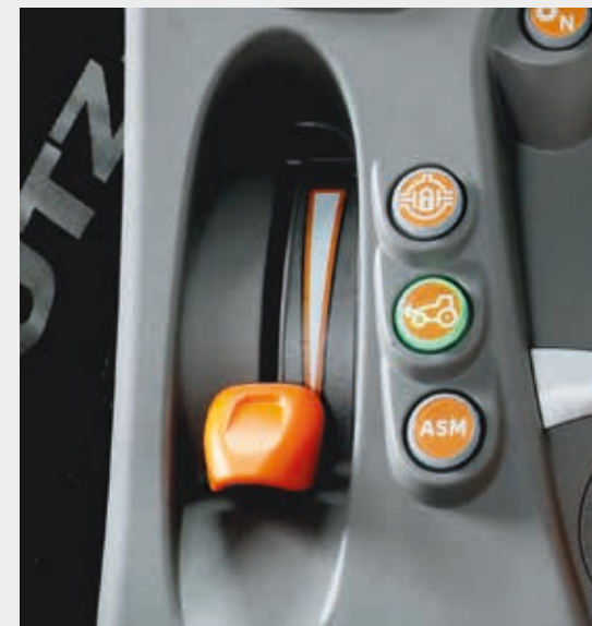
↑ Bağımsız el gazı ve diferansiyel kilidinin elektrohidrolik etkinleşmesi, tüm tekerleklerden çekiş ve ASM işlevi.
