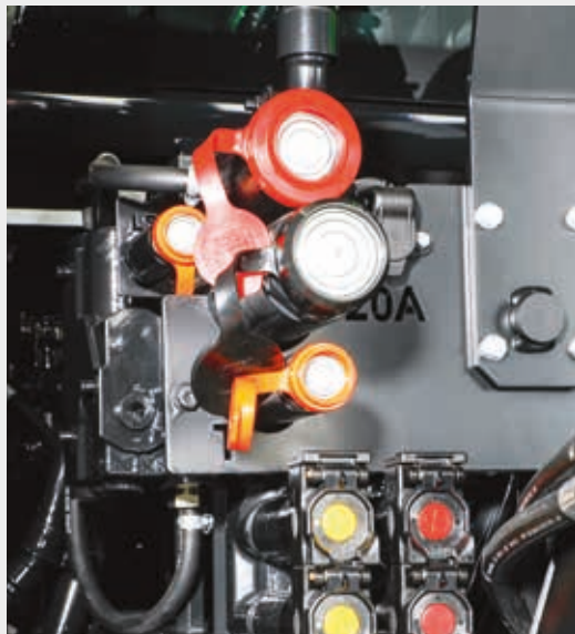
↑ Temiz bir bağlantı için düz yüzeyli kuptörler ile Power Beyond.
