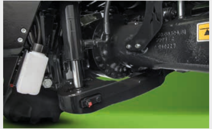
↑ Sağlam bir alt yana açılır kola sahip 6190 TTV ön aksı.
