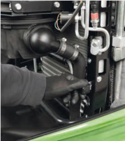
↑ Kolay açma mekanizmasına sahip soğutma paketi.
