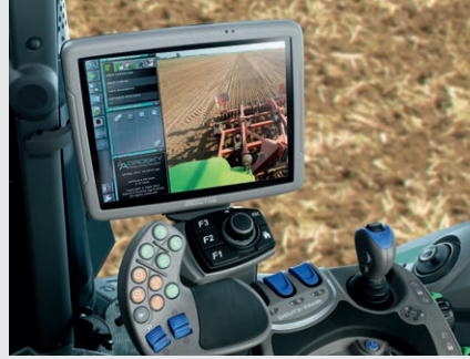
↑ Net bir genel görüş ve güvenlik için otomatik tam ekran moduna (örn. geri gitme) sahip entegre kamera.
