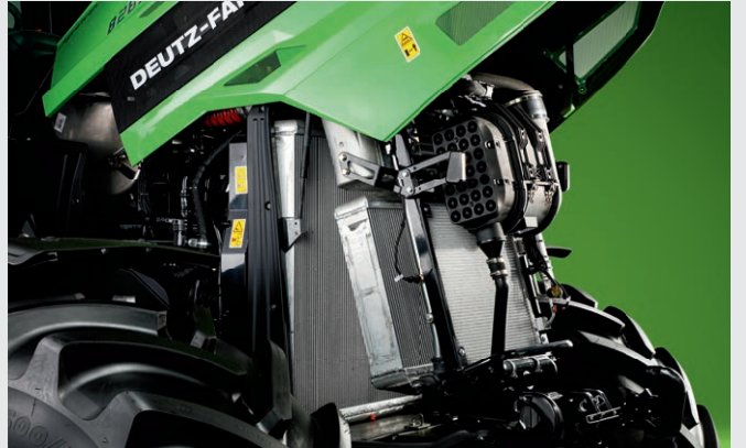
↑ Radyatöre ve hava filtresine kolay erişim.
